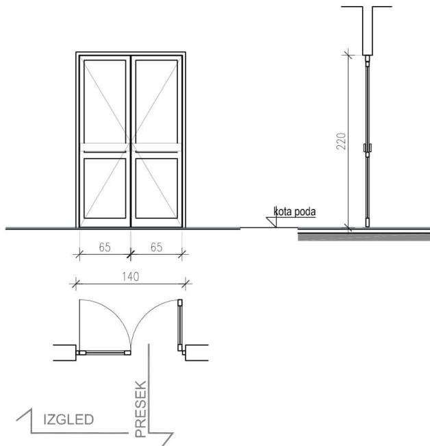
**OPIS:** Izrada i montaža pregrade sa dvokrilnim vratima, od aluminijumskih profila plastificiranih u belo, bez termoprekida. Gornji deo krila se zastavljuje sigurnosnim stakлом 4.4.1, donji deo ispuna od polistirena obostrano obloženog plastificiranim aluminijumskim limom. Krila su opremljena aluminijumskim rukohvatom, otvarajuće krilo automatom za samozatvaranje, a pomoćno krilo riglama za fiksiranje. Okov i brave standardni. Bez praga, sa četkicama sa donje strane krila.
