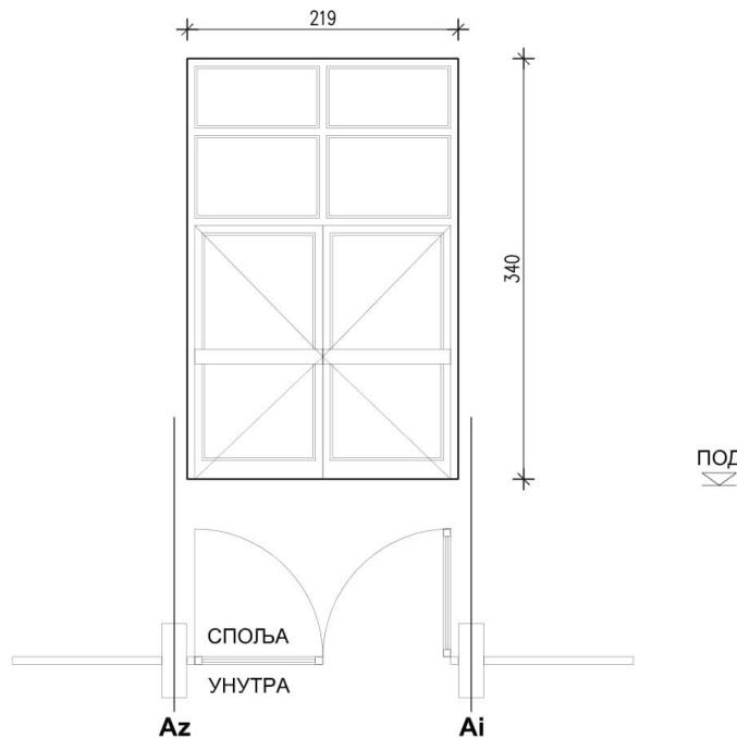
**OPIS:** Izrada i montaža fasadnih dvokrilnih vrata od aluminijumskih profila plastificiranih u belo, sa termoprekidom. Nadsvetlo je fiksno. Krila se zastakljuju sigurnosnim staklopaketom 4.4+16+4.4 ( panpleks ), a nadsvetlo standardnim staklopaketom 4+16+4, sa niskoemisionim stakлом i ispunom od argona.. Krila su opremljena aluminijumskim rukohvatom, otvarajuće krilo automatom za samozatvaranje, a pomoćno krilo riglama za fiksiranje. Okov i brave standardni.
